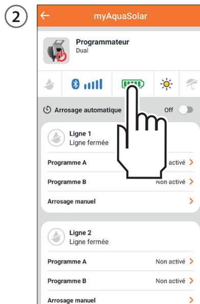
Le niveau d'énergie est également indiqué dans la barre supérieure après avoir ouvert la carte du programmeur. La sélection de l'icône du niveau d'énergie permet d'accéder à d'ultérieures informations.
