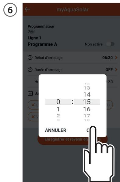
Faites défiler les chiffres des heures et des minutes jusqu'à ce que la durée souhaitée soit atteinte et confirmez. L'arrosage peut être configuré de 1 minute à 3 heures 59 minutes.
