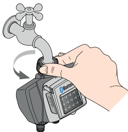
Vissez la bague de serrage de la prise 3/4" femelle sur le robinet.
