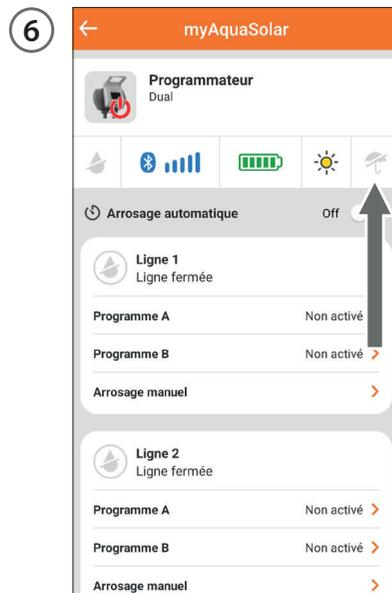
L'état du capteur de pluie peut être visualisé sur la barre supérieure.
