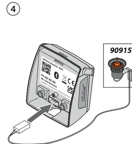
Insérez le connecteur du Rain Sensor. Le capteur sera immédiatement actif. **Attention : si n'est inséré ni le connecteur pont, ni le connecteur du Rain Sensor, le programmeur n'effectuera pas les arrosages automatiques mais seulement ceux manuels.**
