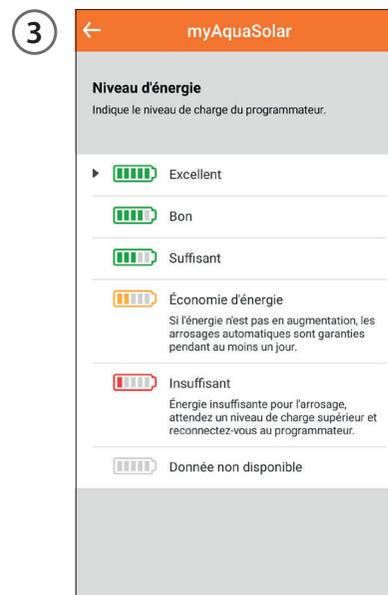
Si l'icône du niveau d'énergie est grise, attendez la fin de la charge (PREMIER OU NOUVEAU DÉMARRAGE). Il existe 5 niveaux d'énergie. Si le niveau d'énergie passe en mode **économie d'énergie** (icône jaune), le programmeur continuera à assurer les arrosages automatiques pendant au moins 1 jour. Si le niveau d'énergie est **insuffisant** (icône rouge), toutes les fonctions seront désactivées, la date et l'heure restant en mémoire pendant environ 16 heures avant de s'éteindre.
