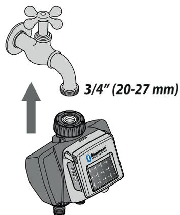
Branchez le programmeur sur un robinet d'eau domestique. Assurez-vous que le robinet soit muni d'un raccord fileté mâle de 3/4" (utilisez un adaptateur, si nécessaire).
