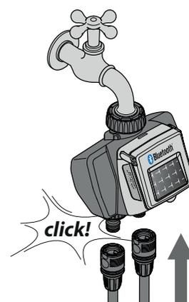
Raccordez les lignes d'arrosage à la prise du programmeur à l'aide de raccords Quick-Click System ou de raccords filetés de 3/4".
